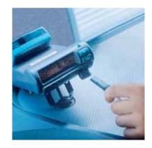
Mit der Software OBU 2.0 bietet das Fahrzeuggerät ab 2006 neben größtmöglichem Komfort noch mehr Funktionalitäten. Nur mit der Software-Version OBU 2.0 können Streckendaten und Mautsätze jederzeit drahtlos per Mobilfunk auf die OBU übertragen werden. Das heißt, das Gerät kann dann Informationen über
